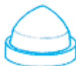
116 - Impression diam. 18 mm hauteur 20 mm Base diam. 25 mm
