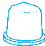
49 - Impression diam. 50 mm hauteur 65 mm Base diam. 66 mm
