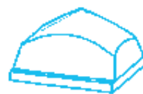
101 - Impression 55 x 40 mm hauteur 49 mm Base 77 x 70 mm
