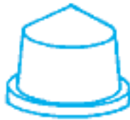
160 - Impression diam. 40 mm hauteur 42 mm Base diam. 45 mm
