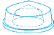
1263 - Impression diam. 120 mm hauteur 86 mm Base diam. 143 mm
