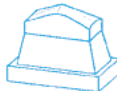
360 - Impression 38 x 16 mm hauteur 38 mm Base 48 x 29 mm
