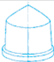
410 - Impression diam. 50 mm hauteur 56 mm Base diam. 60 mm
