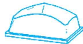
48 - Impression 100 x 60 mm hauteur 63 mm Base 131 x 85 mm
