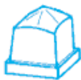
318 - Impression 25x 25 mm hauteur 39 mm Base 33 x 28 mm
