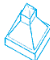
1131 - Impression 8 x 8 mm hauteur 35 mm Base 35 x 35 mm
