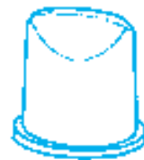
48 - Impression 40 x 25 mm hauteur 64 mm Base diam. 65 mm
