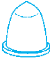
43c - Impression diam. 40 mm hauteur 54 mm Base diam. 66 mm
