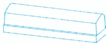
66 - Impression 110 x 25 mm hauteur 33 mm Base 128 x 37 mm
