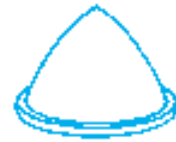
30 - Impression diam. 50 mm hauteur 65 mm Base diam. 91 mm
