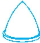
28 - Impression diam. 30mm hauteur 65 mm Base diam. 66 mm
