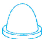
111 - Impression diam. 20 mm hauteur 30 mm Base diam. 35 mm
